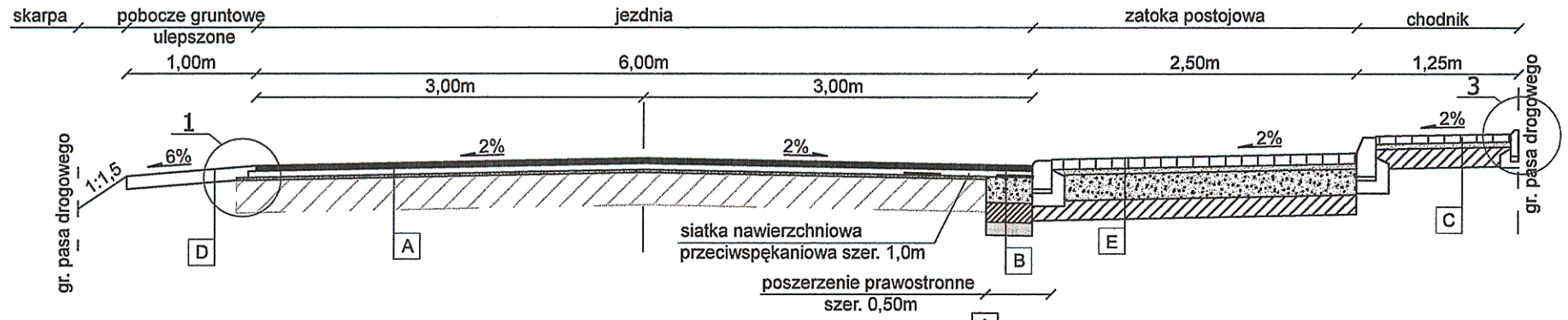
Przekrój normalny nr 6 od km 15+595,00 do km 15+650,00 dł. 55,00m
